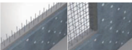
图 3.4 层间企口缝三维示意
